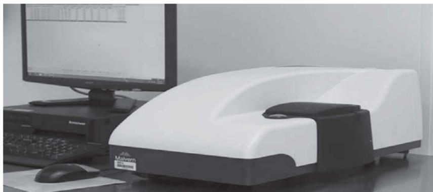
Рисунок 2. Анализатор размера частиц и дзета-потенциала Malvern Zetasizer Nano ZS.
