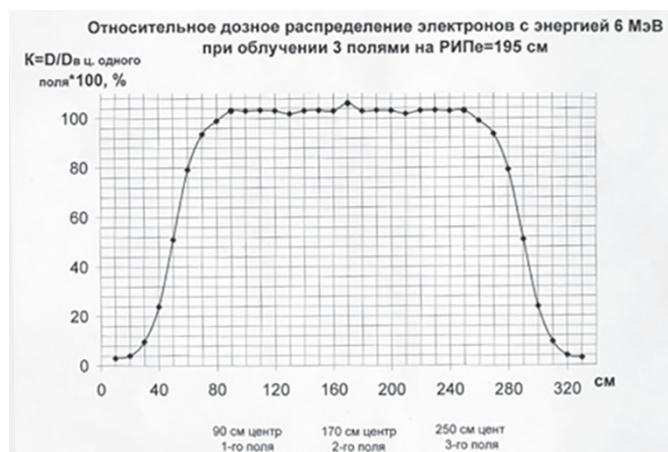
Рисунок 18. Относительное распределение электронов с энергией 6 МэВ при облучении 3 полями на РИП=195 см
